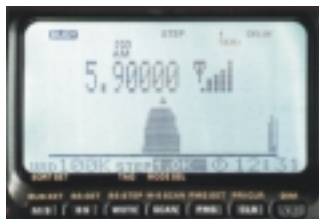
Bandbreite eines DRM-Signals
